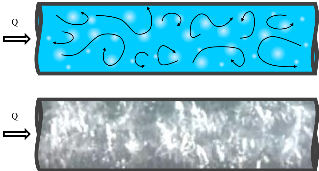
Figura 64 – Gráfico y fotografía de un escurrimiento turbulento a presión.
