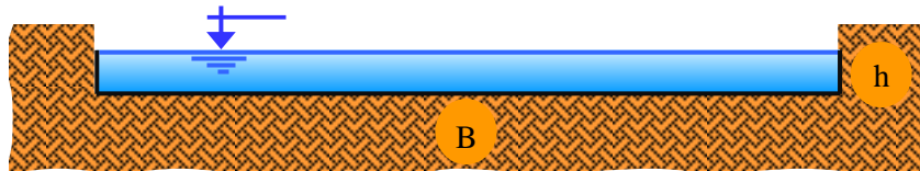
Figura 129 – Canal rectangular con ancho prevaleciente sobre el tirante.
